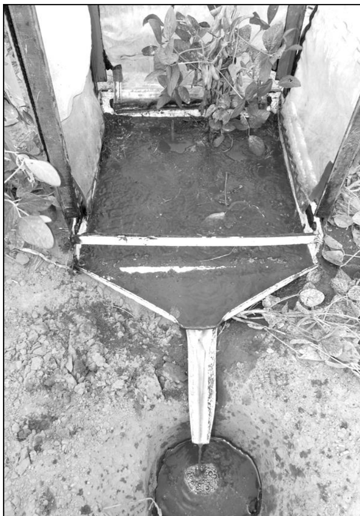
Figura 11. Detalle parcela del microsimulador de lluvias. Alto escurrimiento en monocultura de soja (La Pampa).
